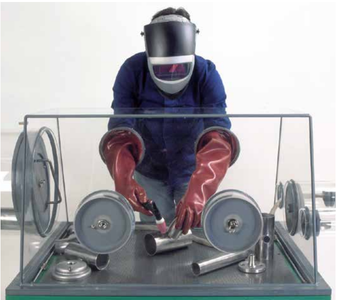
Kammer zum Schweißen in Inertgas-Atmosphäre, Bild: E. Jankus
