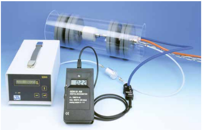
Messeinrichtungen zum Bestimmen des Restsauerstoffgehaltes, Bild: E. Jankus
