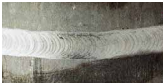
Titanstabilisierter Rostfrei-Stahl: formiert mit Ar/H 2
