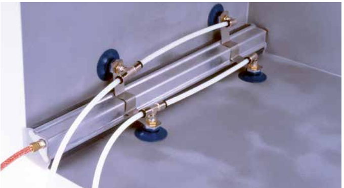
Formiereinrichtung für Kehlnähte, Bild: E. Jankus
