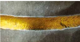
Titanstabilisierter Rostfrei-Stahl: Gelbfärbung unter N 2 /H 2
